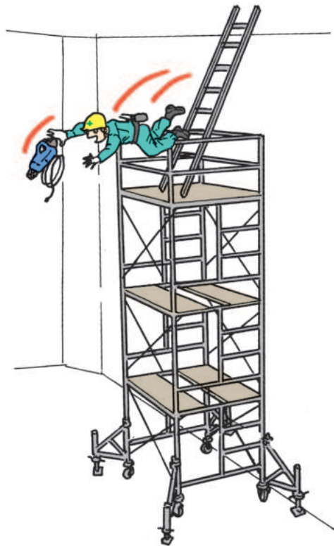
図3-10 移動式足場上ではしごを使用しない
