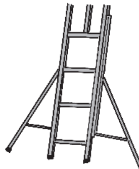
図3-7 安定性補助金具で安定させる一例
