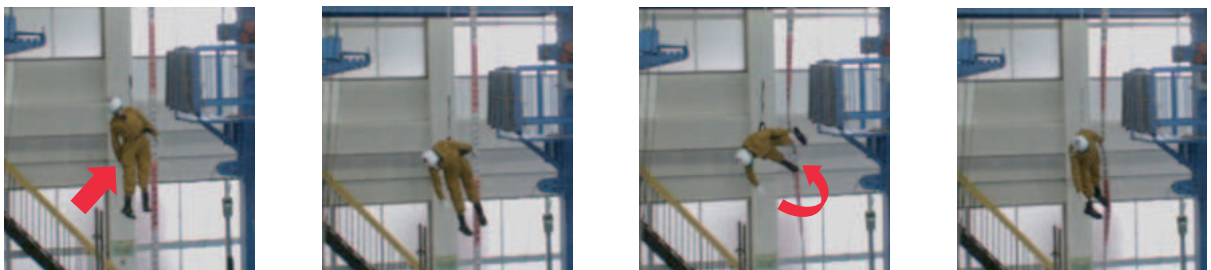
図4-12 胴ベルト型の人体ダミーの挙動
