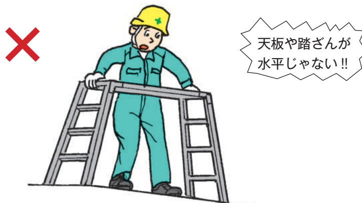
図3-32 軟弱地盤・傾斜地に設置しない
