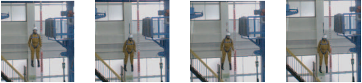
図4-11 フルハーネス型の人体ダミーの挙動
